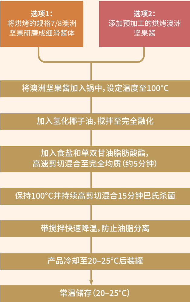
图 1: 细滑型澳洲坚果酱加工流程图
